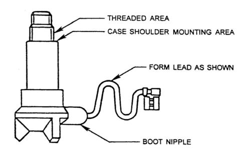
FIGURE 1 TYPICAL D-2000 / D-3000 CAPACITOR
